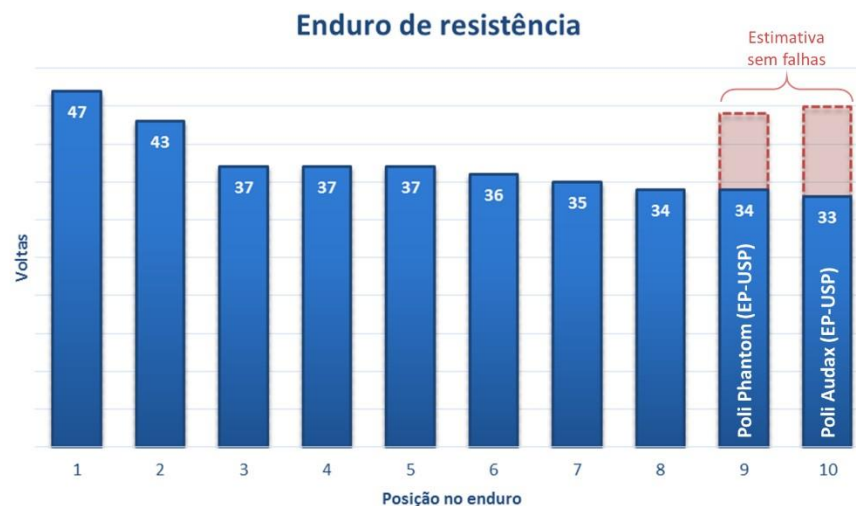
Figura 1 – Número estimado de voltas dos 10 primeiros colocados no enduro de resistência na 20ª Competição Baja SAE Brasil – Petrobras. Dados baseados em SAE Brasil (2014).
